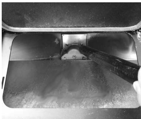
Fig. 22 - Czyszczenie zbiornika i ślimaka
